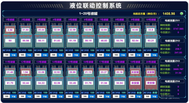
液位联动控制系统 · 1-20 号液罐统一监控
